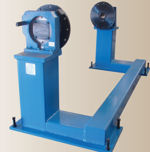
Standard Spindelstock und Reitstock an der Podest-Rotationsanlage installiert
