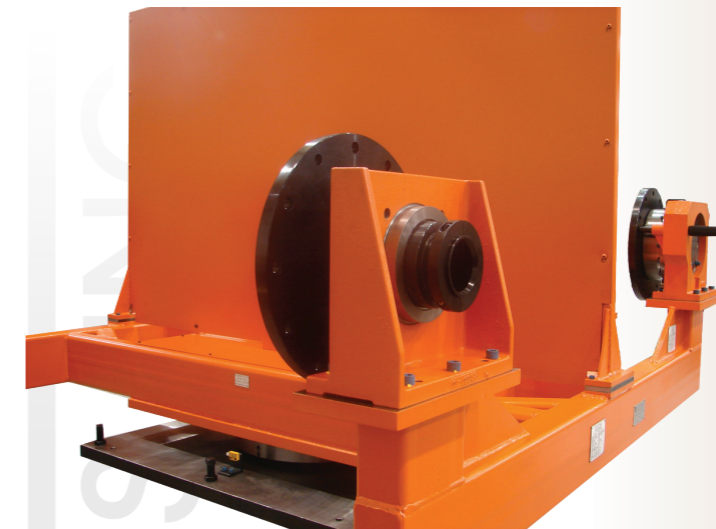
Standard Spindelstock und Reitstock am Doppel-Rotationsanlagen-Drehtisch installiert
